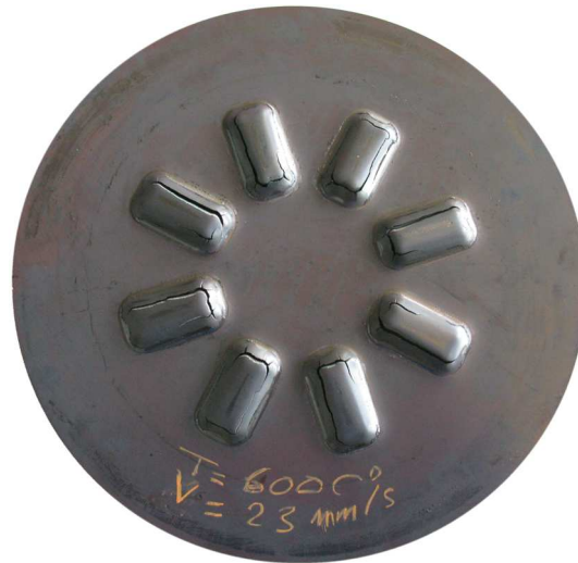
Bild 64: umgeformte Probe bei 600 C° und 23 mmS -1
