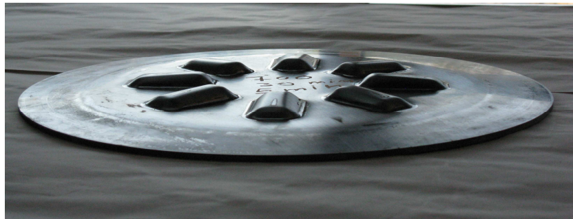
Bild 68: umgeformte Probe bei 700° C, Abkühlung im geschlossenen Werkzeug
