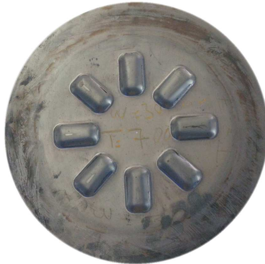
Bild 66: umgeformte Probe bei 700°C
