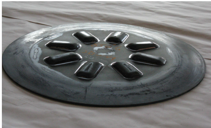
Bild 70: umgeformte Probe bei 850° C, Abkühlung im geschlossenen Werkzeug
