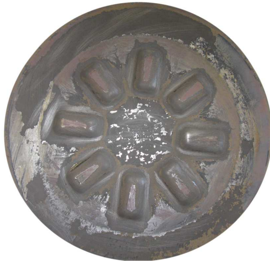
Bild 71: umgeformte Probe bei 1050° C, Abkühlung im geschlossenen Werkzeug
