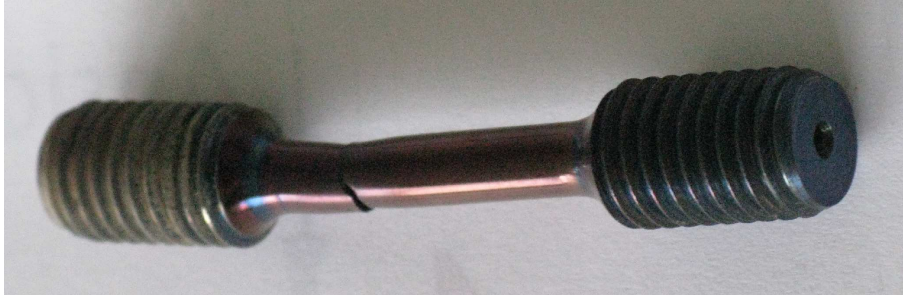
Bild 50: gezogene Probe bei 300 C°
