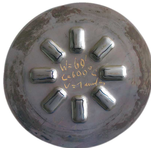
Bild 65: umgeformte Probe bei 600° C und 1mmS -1
