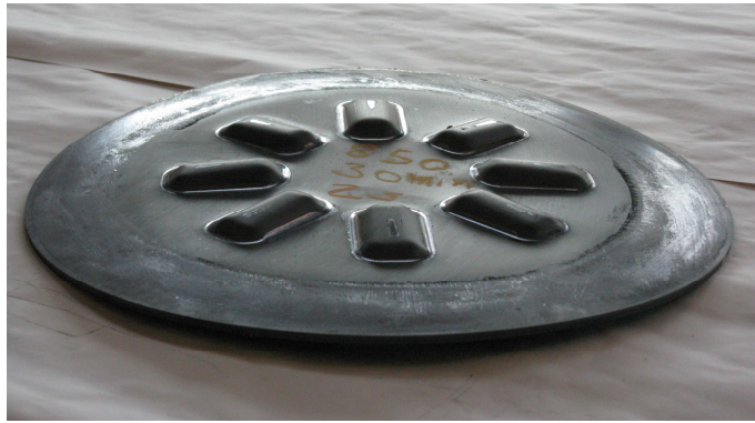
Bild 69: umgeformte Probe bei 850° C, Abkühlung an Luft
