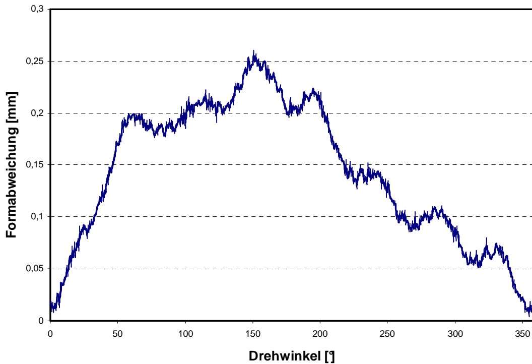
Bild 92: Formabweichung des bei 700° C umgeformten Messers
