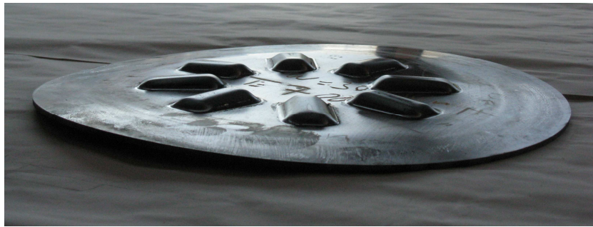
Bild 67: umgeformte Probe bei 700° C, Abkühlung an Luft
