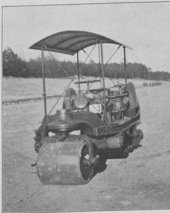
Abbildung 9. Motorwalze von 5,4 t Betriebsgewicht.
