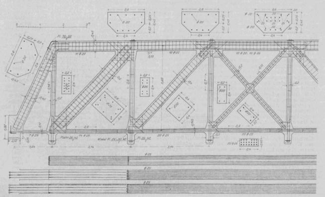
Stahlstäbe und ihre Anordnung geht aus der Konstruktionszeichnung deutlich hervor. Da die Abmessungen der Untergurtstäbe so gewählt sind, daß sie Stöße nicht gestatten, gehen die 7 Stahlstäbe von 25 mm Durchm. in einer Länge von rd. 18 m ohne Stoß durch die Träger hindurch. Es sei noch besonders darauf hingewiesen, daß in den Knoten an den Füßen der Diagonalen eiserne Schuhe einbetoniert sind, die einmal den schräg wir-
