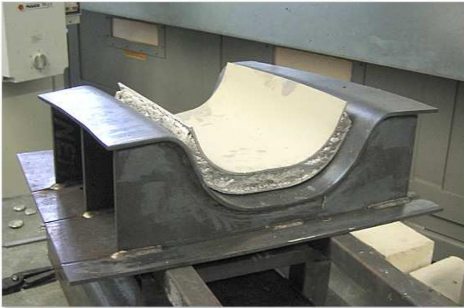
**Bild 58: Matte Oberfläche des Bauteils (SiC-Schichte)**
