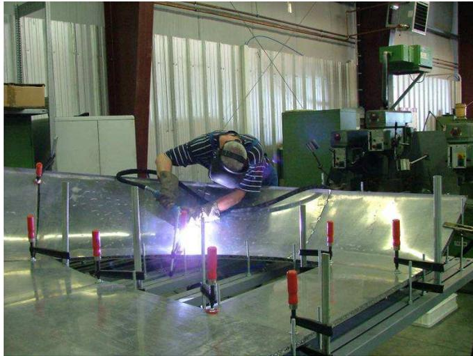
**Bild 100: Heften der Teile durch Schweißen**
