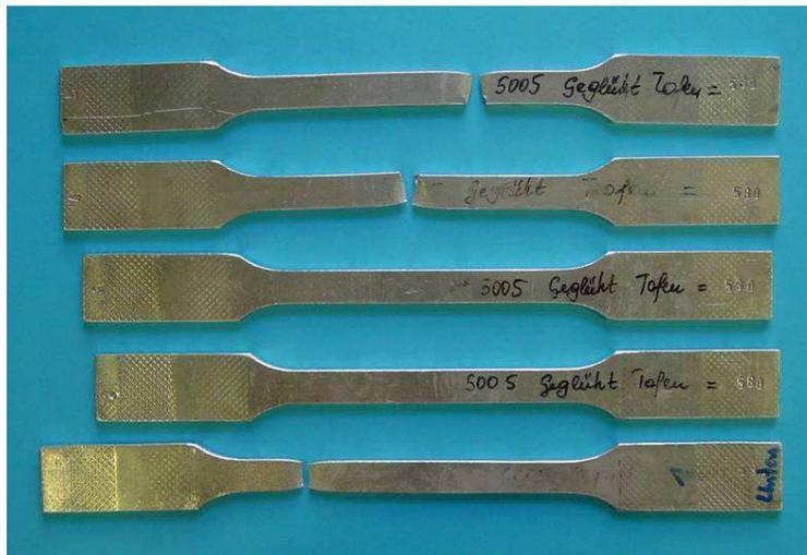
**Bild 31: Wärmebehandelte Proben nach dem Dauerfestigkeitsversuch**
