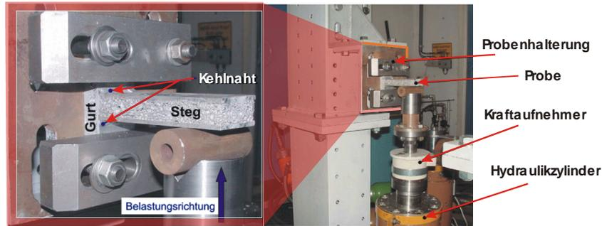
**Bild 68: Prüfeinrichtung zum Test der T-Stoßverbindung**
