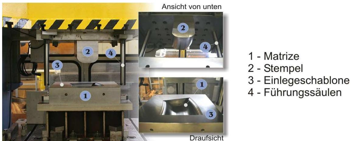
**Bild 34: Umformwerkzeug zur Herstellung der Sandwichrinne**
