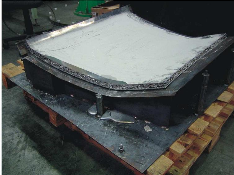
**Bild 97: Ein Teil der A-Säule nach dem Abschneiden der Ränder**
