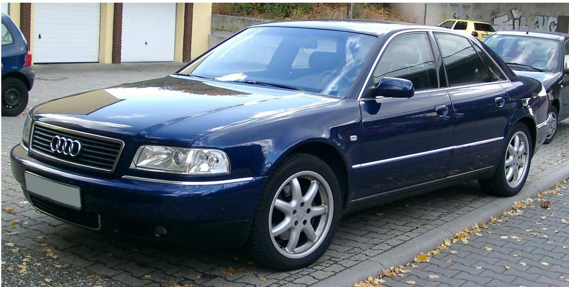
**Bild 4: Audi A8 mit Aluminiumkarosserie (Bild: Wikipedia/Rudolf Stricker)**
