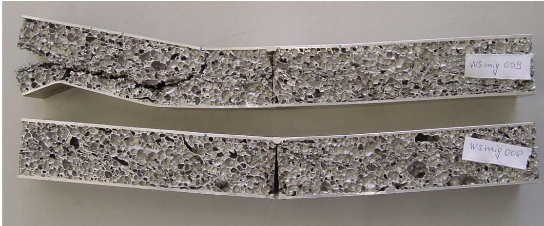
**Bild 67: Versagensfälle beim 4-Punkt-Biegeversuch**
