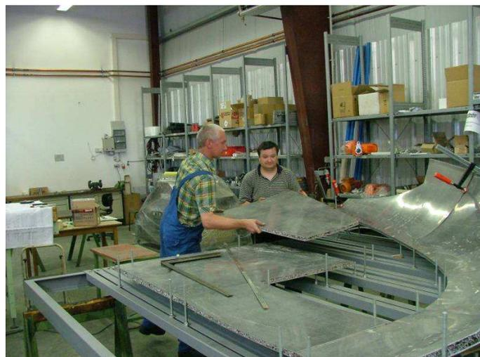
**Bild 99: Einlegen einzelner Bauteile in die Vorrichtung**
