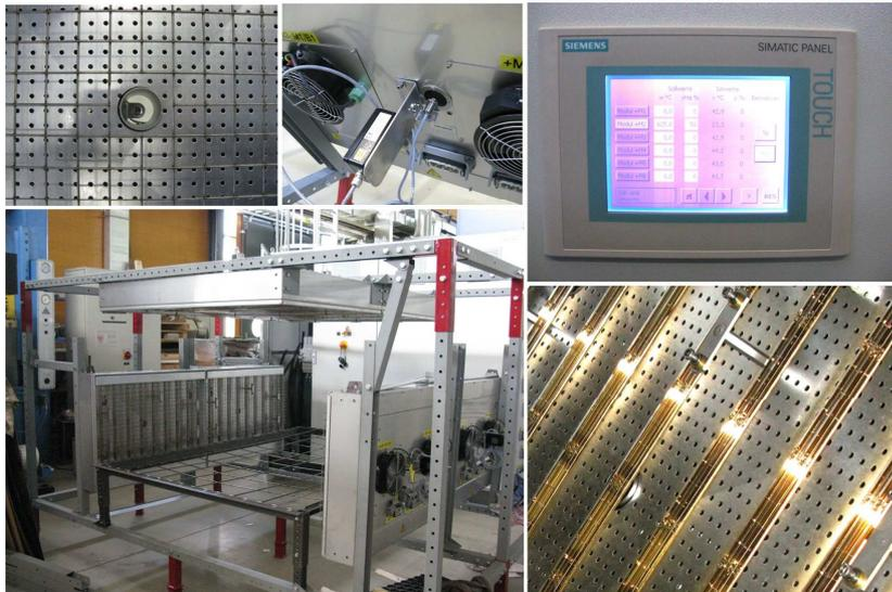
**Bild 51: Infrarot-Aufschäumeinrichtung (Strahler, Pyrometer, SPS-Steuerung Panel)**
