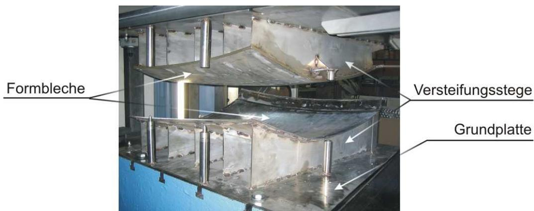
**Bild 89: Das zusammengebaute Werkzeug zum Umformen eines Teils des Frontmoduls**
