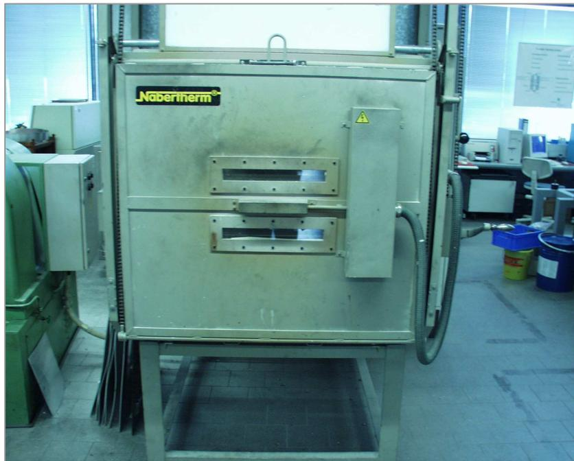
**Bild 54: Der Ofen zum Aufschäumen von AFS (IFAM)**
