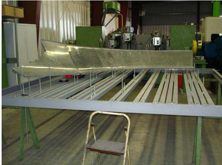
**Bild 98: Vorrichtung zum Schweißen der Seitenwand**
