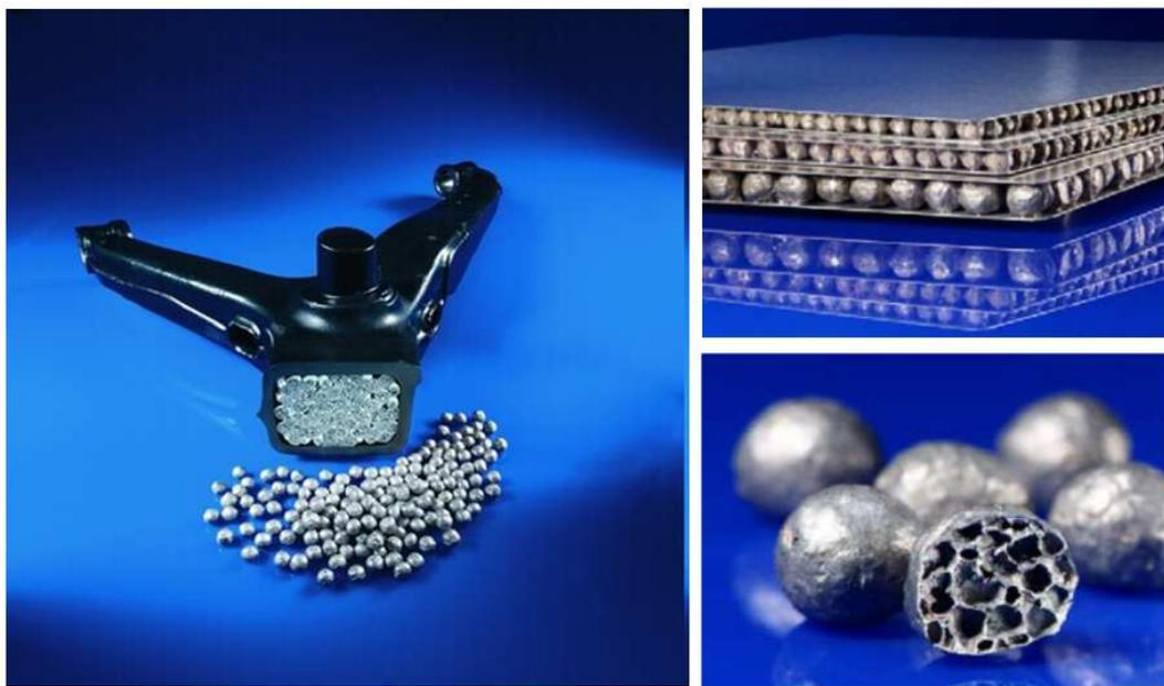
**Bild 23: APM-Technologie zur Herstellung von Schaumbauteilen, nach [ifam, NNif05]**
