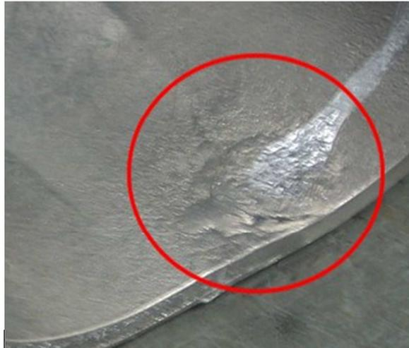
**Bild 55: Probe mit einem verschmolzenen Deckblech**
