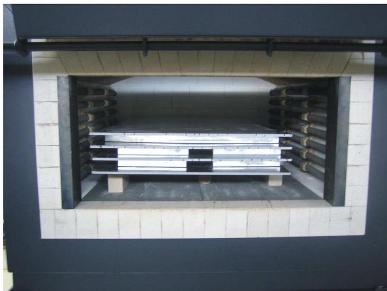
**Bild 92: Erwärmung der Sandwichplatten zum Umformen**
