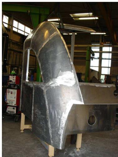
**Bild 101: Das zusammengefügte ITINO-Frontmodul**
