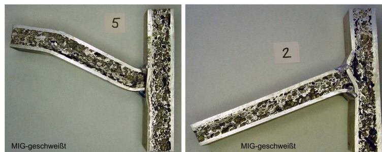
**Bild 69: Versagenskriterien an der T-Stoßverbindungen; links: Versagen des Stegs, rechts: Delamination im Gurt**
