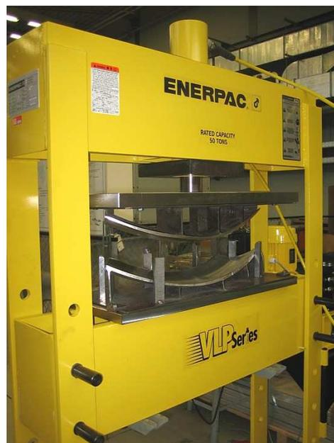
**Bild 40: Transportable 50t-Druckvorrichtung mit dem eingebauten Umformwerkzeug**
