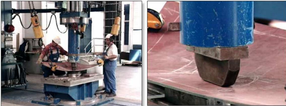
**Bild 38: 3D-Biegen zur Herstellung von Werkzeugen**
