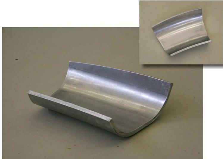
**Bild 37: Das umgeformte Bauteil „Sandwichrinne“**
