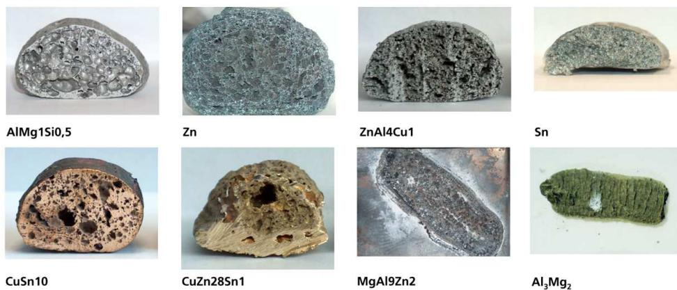
**Bild 14: Schäume aus verschiedenen Metallen [iwu]**
