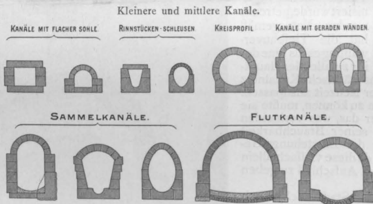
Abbildg. 2. Aeltere Kanalprofile.
