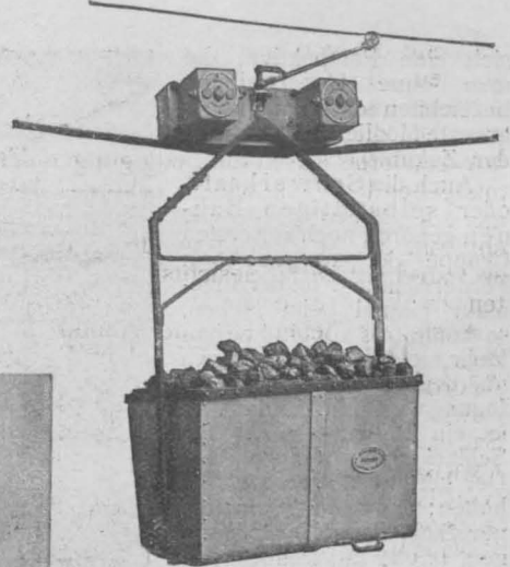
Abbildg. 10. Elektr. Hängebahnwagen.
