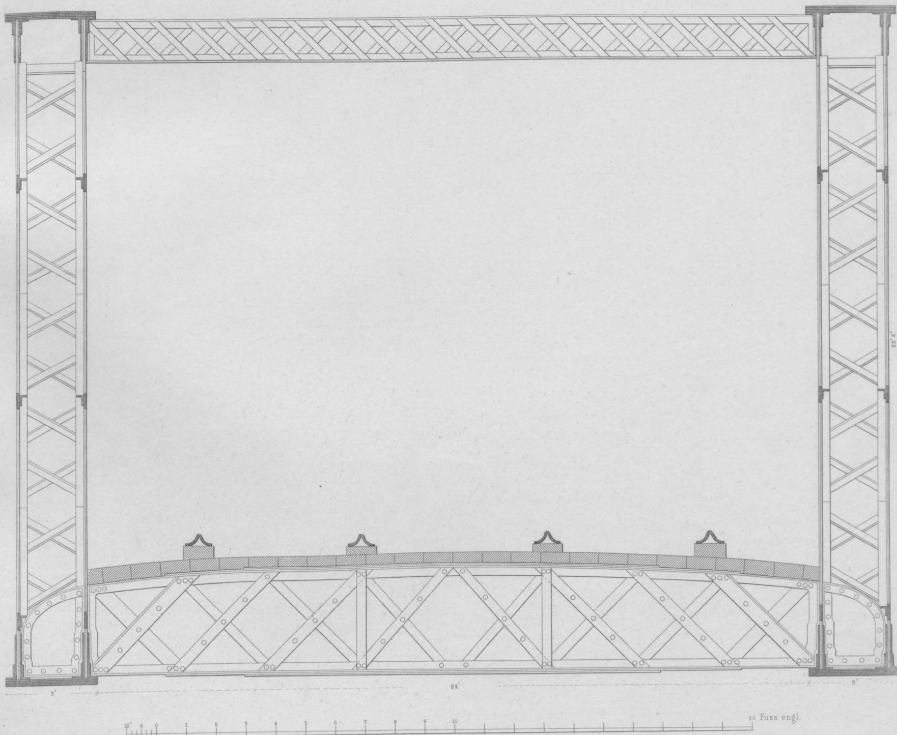
Querprofil der Brücke.
