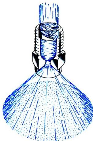
Abb. 25: Einstoffdüse mit Drallkörper
