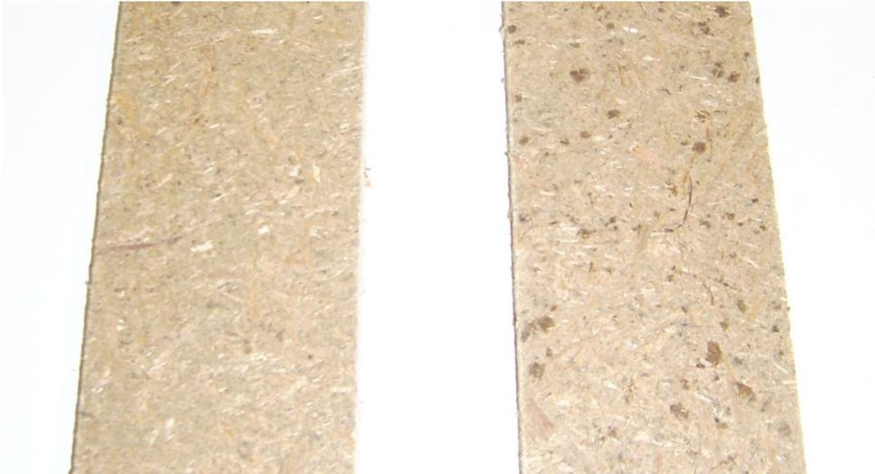
Abb. 68: Platten mit guter Bindemittelverteilung (links aus Versuchsnummer 1 hergestellt),
