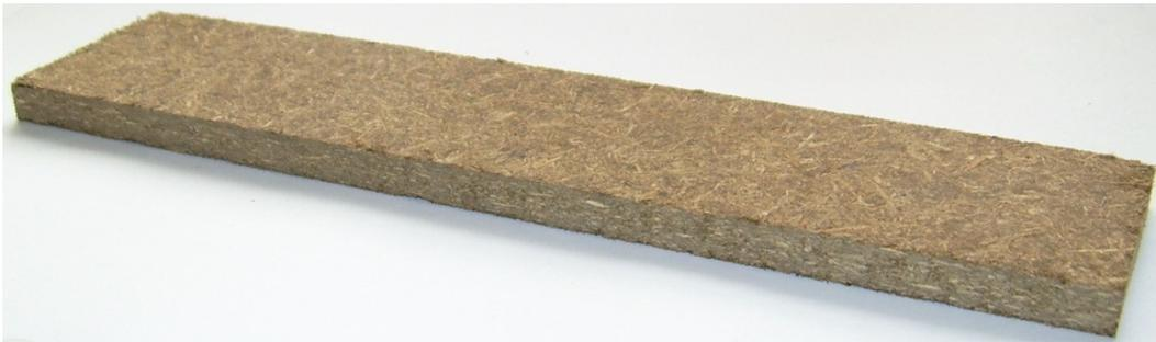
*Abb. 5: Faserplatte (Prüfkörper) aus Hanfsilage in der Pilotanlage im Leibniz-Institut für Agrartechnik Potsdam-Bornim e. V. (ATB) hergestellt*
