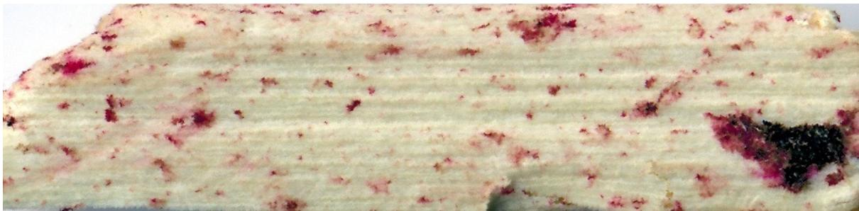
Abb. 69: Eine Schäbe der Dimension 12,6 x 3,5mm aus dem Versuchsnummer 1, mit rot gefärbtem Bindemittel besprüht
