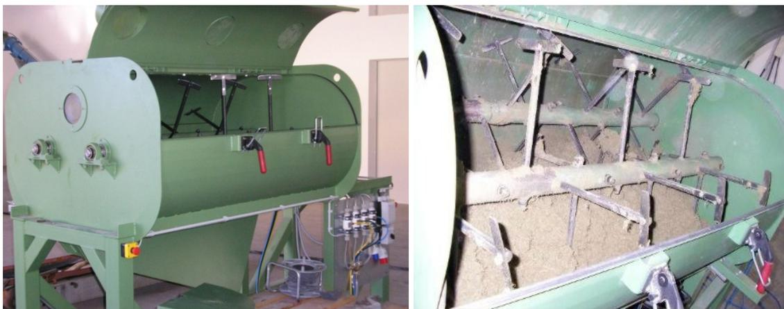
Abb. 42: Belemischer, Pilotanlage des Leibniz-Instituts für Agrartechnik Potsdam-Bornim e. V. (ATB), Seitenansicht (links), Mischraum mit dem Faserstoff befüllt (rechts)
