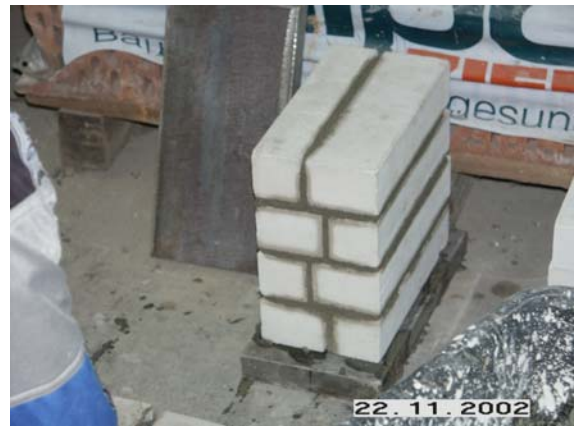
Abb. IV-133: Probekörper zur Ermittlung der Mauerwerksfestigkeit
