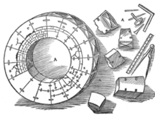
Abb. III-11: Verzahnung. In Rivius [1547] (1981), Von der grundtlegung / erbawung, Blatt XXII verso
