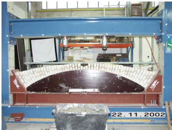
Abb. IV-132: Zeitgleiche Herstellung des Bogens und der Prüfkörper. Lehrgerüst und Probekörper in der Unterkonstruktion im Prüfraumen
