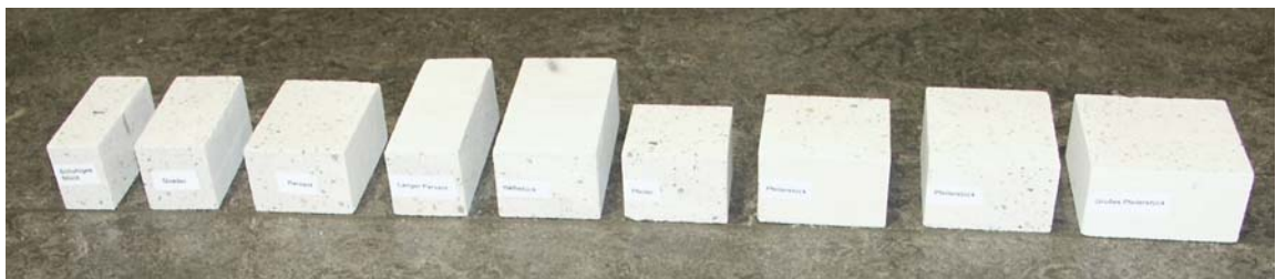
Abb. III-31: Größenproportionen der Nürnberger Normmaße für Naturstein. Von links nach rechts entsprechend der obigen Tabelle von oben nach unten (Aufstandsfläche Breite x Länge). Zuschnitt und Foto C. Kaiser
