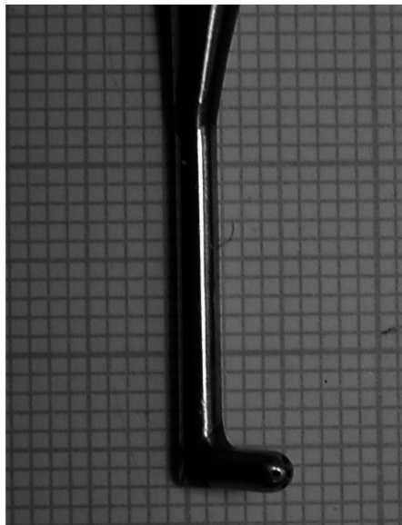
Abbildung A.1: 5-Lochsonde, Bauart und Spende des DLR
