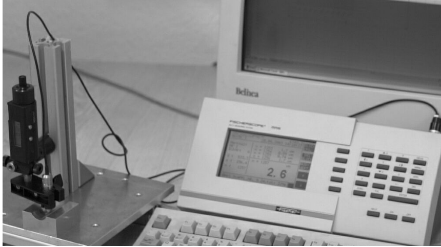
Abbildung 5.1: Wirbelstromsonde zur Schichtdickenmessung (links), mit Auswerteeinheit (rechts)
