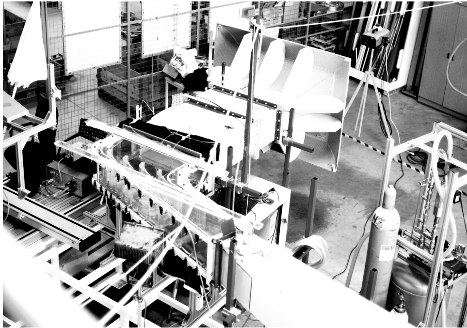
Abbildung 3.2: Detailansicht Windkanal: Einlauf und Kaskade
