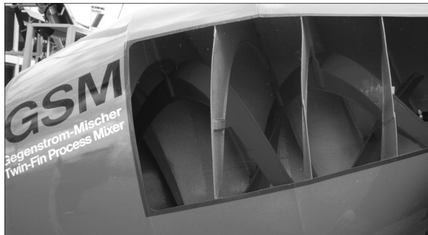
Abbildung 24: Ansicht einer Gegenstromschnecke in einer Fahrmischertrommel.
