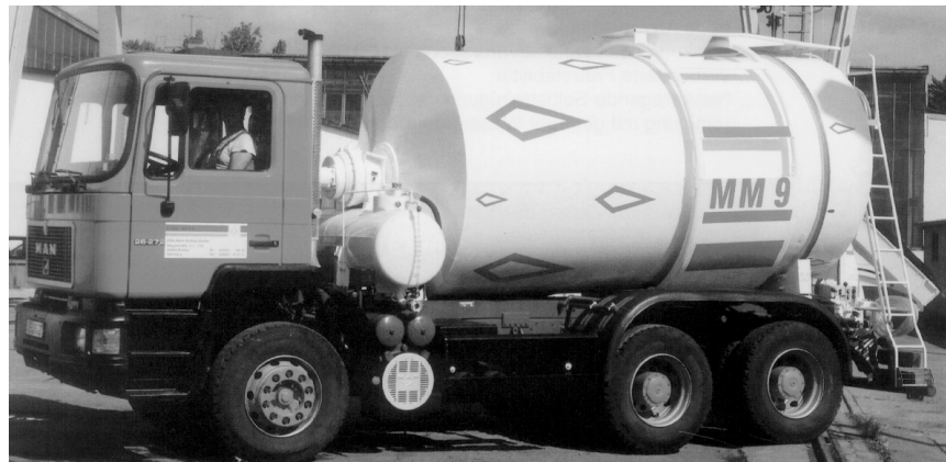
Abbildung 4: Maximixer MM9 mit maximal 8 m 3 Fassungsvermögen bei Normalbeton [44].
