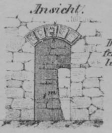
Die Rettungsnischen sind in Entfernungen von 25 m abwechselnd links und rechts angebracht.
