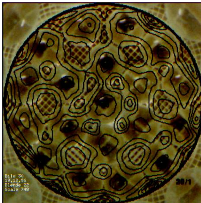
Abbildung 9-12: Überlagerung der ersten Kugellage und der Isolinien der gemessenen Strömungsgeschwindigkeiten ( a_{pt} = 0,2 , a_{Hp} = 1 , u_0 = 0,40 )
