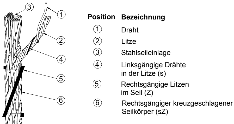
Bild 2-4: Konstruktion eines kreuzgeschlagenen rechtsgängigen Drahtseils
