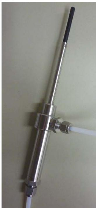
Abbildung 13.5: SPME-Anreicherungseinheit.<sup>[133, 134]</sup>
