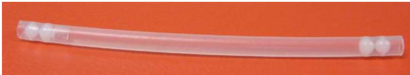
Abbildung 4.4: Permeationsröhrchen mit 60 mm Länge aus Polyethylen (PE).
