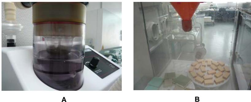
Abbildung 8.1: Schema Ultraschall-Aerosol-Beimpfung, 10 mL Sporensuspension im Ultraschallbad (A); zu beimpfende Baumaterialien, auf denen das Sporenaerosol durch den orangefarbenen Trichter verteilt wird (B).
