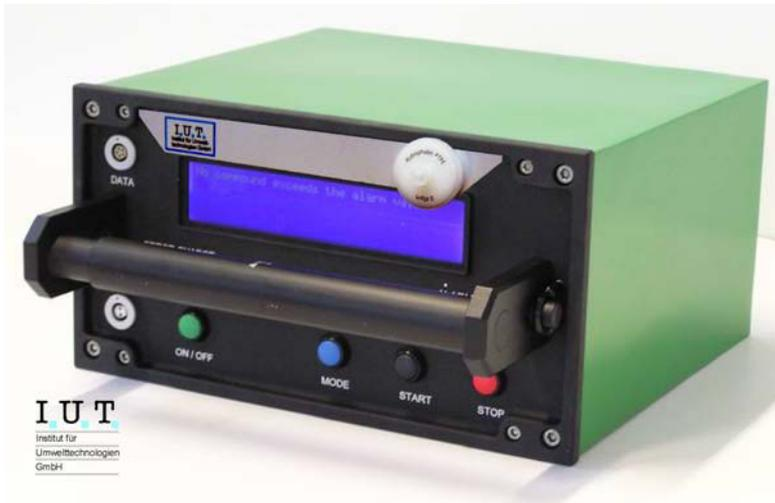
Abbildung 2.2: Verwendetes Ionenmobilitätsspektrometer - IMS-MINI.<sup>[67]</sup>
