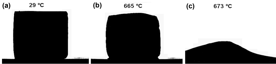
Abb. 4.4: Benetzungsverhalten des (\text{LiF-SrCO}_3) -Additivsystems auf der \text{BaTiO}_3 -Unterlage (mittels Erhitzungsmikroskop).
