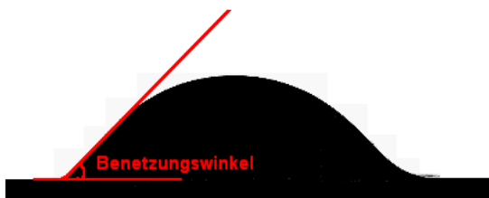
Abb. 3.3: Bestimmung der Benetzungswinkel im Bild des Erhitzungsmikroskops.
