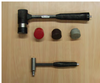
Abbildung 7.1: Impulshämmer PCB Piezotronics 086D20 (1,1 kg, oben, mit verschiedenen harten Schlagköpfen) und 086C03 (0,16 kg, unten).
