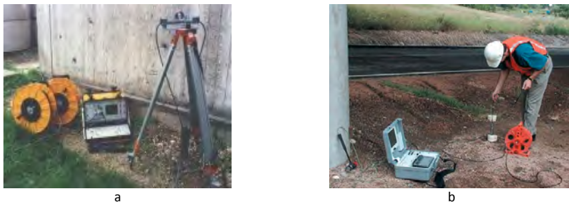
Abbildung 3.2: Kommerzielle Parallel-Seismik Ausrüstungen der Firmen CEBTP (a) und Olson Engineering (b).
