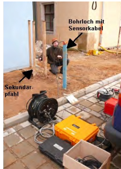
Abbildung E.11 (rechts): Parallel-Seismik-Messungen auf Sekundärpfahl in Grimma (Februar 2008).
