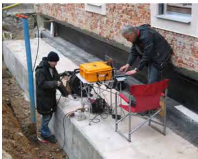
Abbildung E.12: Messungen in Grimma auf dem Kopfbalken über der Pfahlwand.
