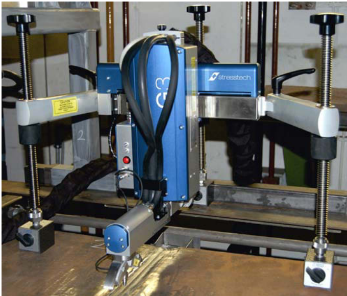
Bild 3.7: Mobiles Röntgendiffraktometer Stresstech G3
