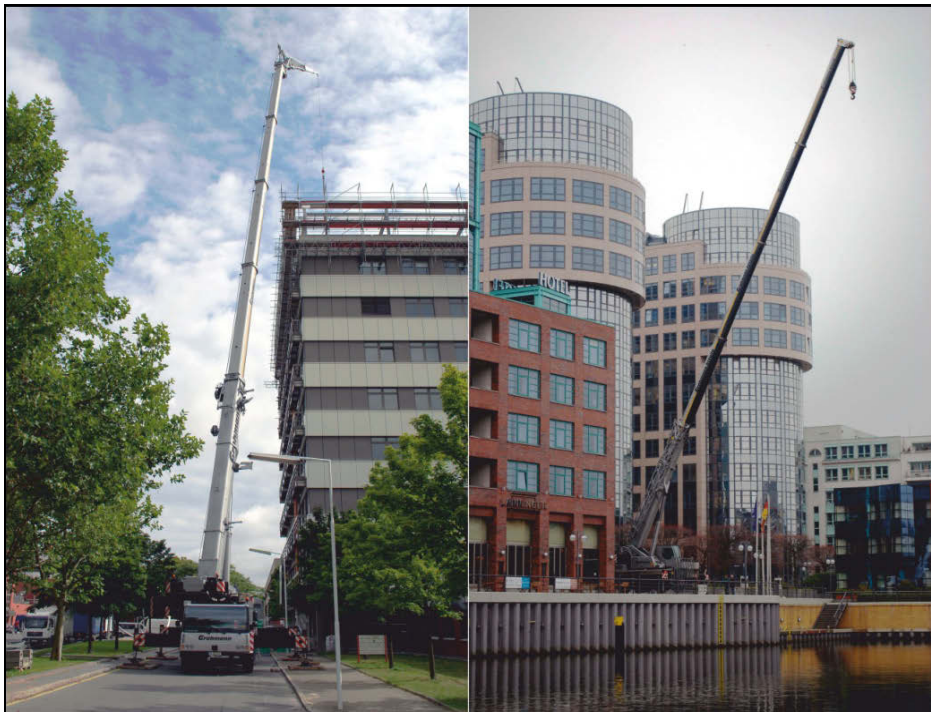
Bild 1.1: Teleskopausleger von Mobilkränen sind ein typisches Anwendungsfeld hochfester Stähle.
