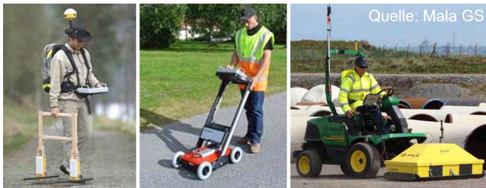
Abbildung 2-13 Halbautomatische Radarsysteme mit ortsreferenzierter Datenaufnahme per Global Positioning System (GPS)
