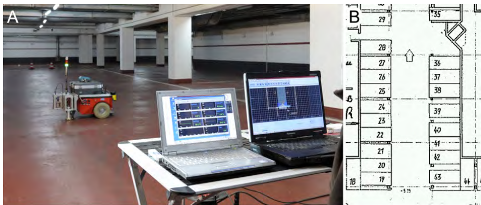
Abbildung 5-8 A: Parkhausuntergeschoss mit Roboterplattform und Rechner zur (zeitnahen) Visualisierung und Steuerung, B: Grundriss des Messfeldes 1 mit nummerierten Einstellplätzen
