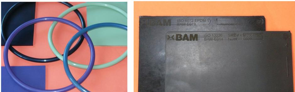
Abbildung 3.2: Erworbene O-Ringe und Platten (links) sowie in der BAM hergestellte Referenzmaterialien (rechts).
