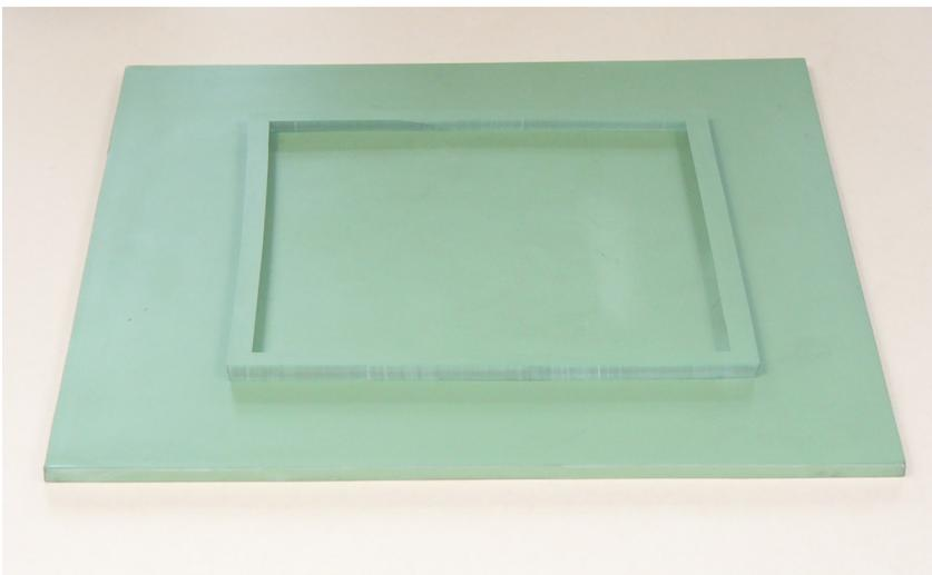
Abbildung 4.10: Hergestellte Dichtung und Prüfplatte. Parker FKM
