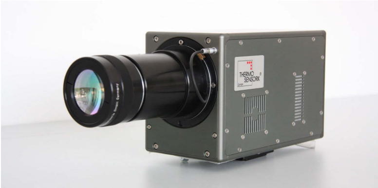
Abbildung 3.1: Foto der InSb-basierten Thermografekamera der BAM 8.4, Kurzname INA.
