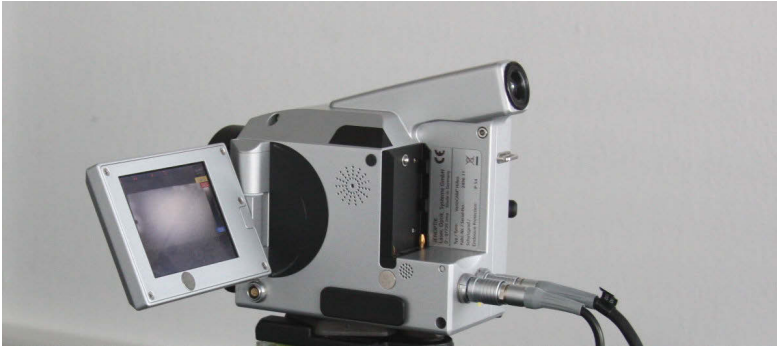
Abbildung 3.2: Foto der Mikrobolometer-basierten Thermografiekamera der BAM 8.4, Kurzname INA.
