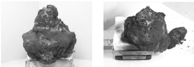
Abbildung 5.54 Cone-Rückstände von RTM6+DMPOAc-3-THIC (links) und RTM6+DDPO-3-THIC (rechts) bei 35 kW m<sup>-2</sup>
