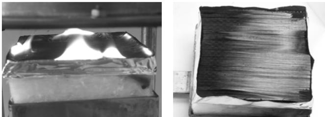
*Abbildung 6.1 Links: DGEBA/DMC-CF am Ende des Brandes rechts: Rückstand von DGEBA/DMC-CF (bei 50 kW m<sup>-2</sup>)*
