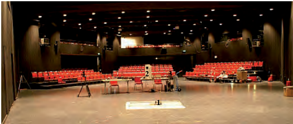
Abbildung 23: Bild des Messaufbaus im „Kleinen Saal“ in den Städtischen Bühnen Münster, Deutschland (1 = Abbrandort, 2 = Aerosolmessungen, 3 = Gasmessungen, 4 = Schalldruckmessungen)
