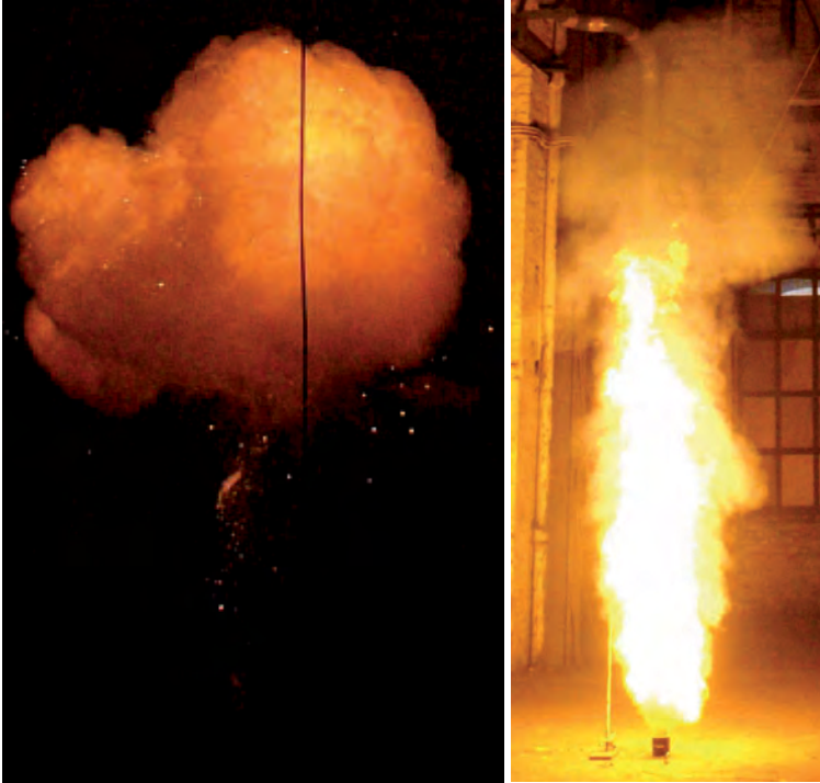
Abbildung 86: Flammeneffekte während der Umsetzung bei den Messungen in dem ehemaligen Kesselhaus der Werkshalle 21 in Wildau; links: Feuerball, rechts: Flammensäule
