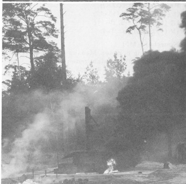
Bild 13 und 14 Auswirkungen beim Bersten überladener Acetylenflaschen
