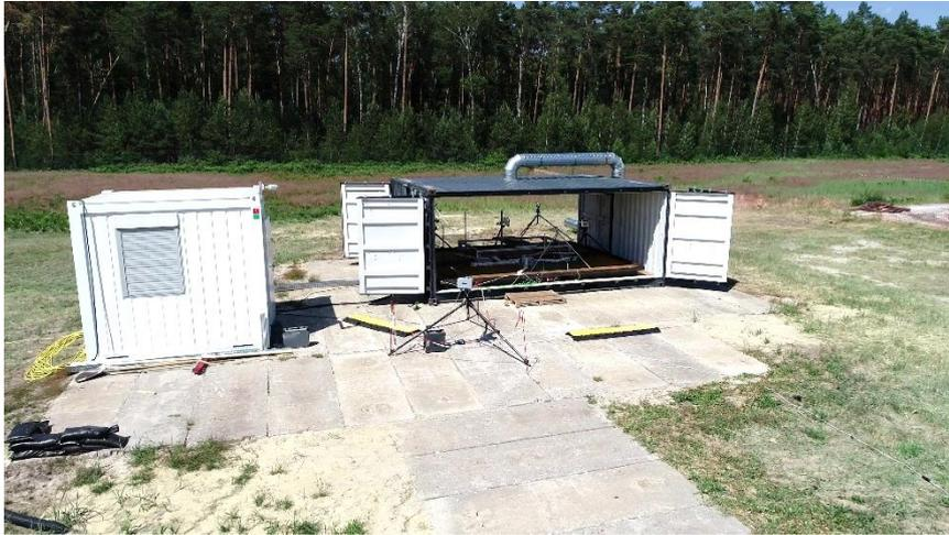
Abb. 1: Großversuchsstand zur Untersuchung der Auswirkungen des TR von LIB auf dem BAM TTS.
