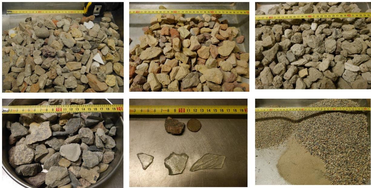
*Abbildung 10. Fotos der einzelnen Stoffgruppen und Siebfraktionen (von links oben nach rechts unten: >16mm unsortiert, >16 mm Ziegel, >16 mm Mörtel, >16 mm Steine, >16 mm Glas und Metall und gemeinsam <0,63, <2 und <4 mm).*
