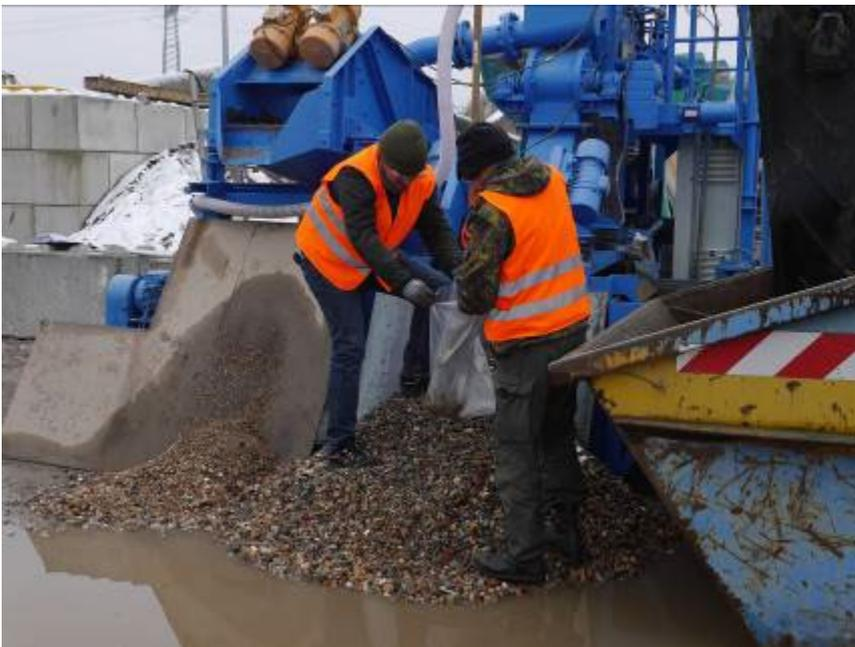
Abbildung 9. Probenahme der Outputfraktionen: Leichtfraktion (linker Haufen), Schwerfraktion (rechter Haufen), Feinstfraktion (im nebenstehenden Container).
