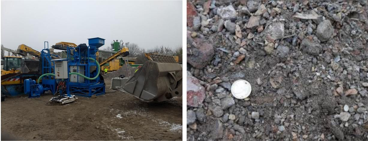
Abbildung 8. Die Setzmaschine Triple A von AGS aufgestellt bei einem Recyclingbetrieb in Berlin (links), gemischter Bauschutt als Inputmaterial (rechts, Euro-Münze als Größenvergleich).
