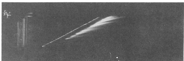
Abb. 5 Sprengstoff entsprechend Abb. 4 b Aufnahme mit Zeitauflösung (Drehspiegel) Zeitachse waagrecht, nach rechts ansteigende Zeitwerte
