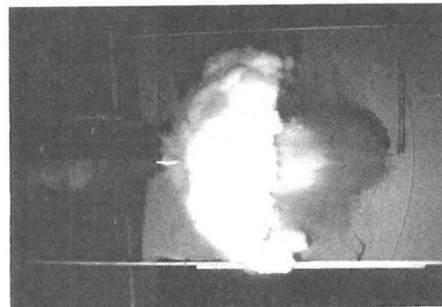
Abb. 6 Waagrecht frei hängende Ladung in Detonation Schattenschlierenaufnahme mittels zweier detonativ erzeugter Lichtblitze; Blitzdauer 1 \mu\text{s} ; Zeitdifferenz \sim 100 \mu\text{s} (Luftstoßwelle doppelt erfaßt)
