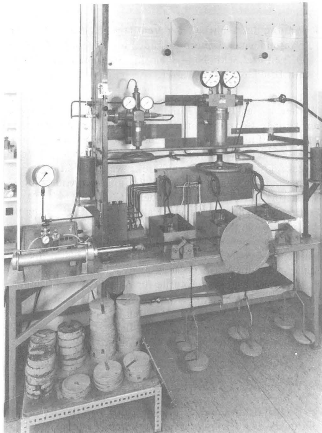
Bild 1 Apparatur zur Prüfung von Ausrüstungsteilen nach § 14 Druckgasverordnung (Bauartzulassung)
