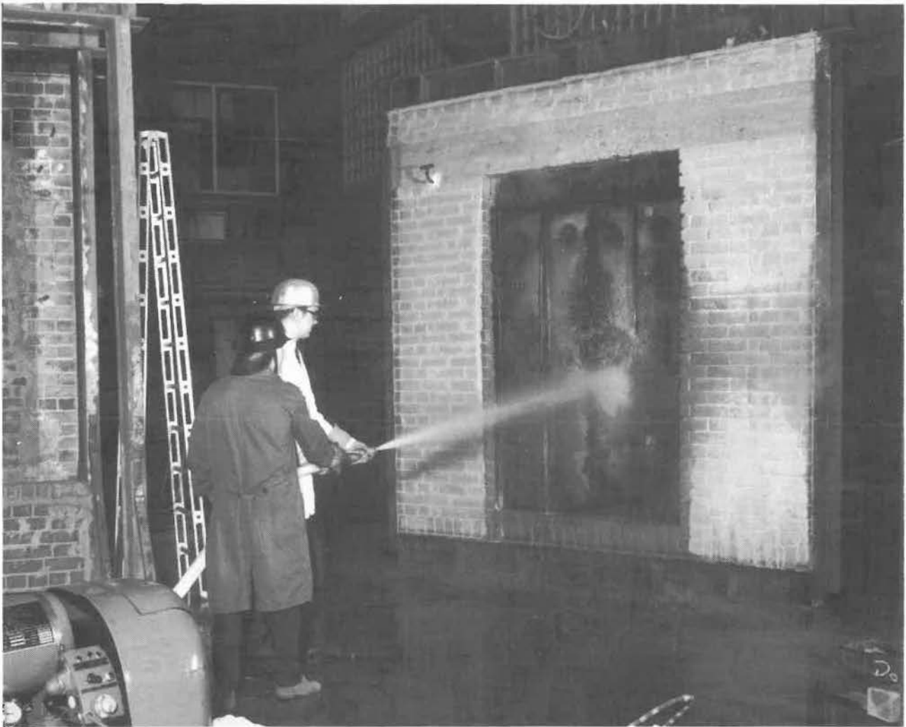
Löschwasserversuch in der BAM an einer Fahrschachttür im Anschluß an einen Brandversuch
