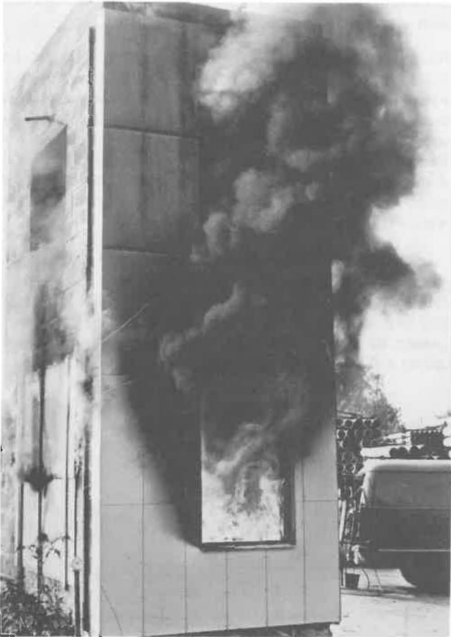
Bild 1 Brandversuch im Maßstab 1 : 1 (Fensterhöhe 1,6 m)
