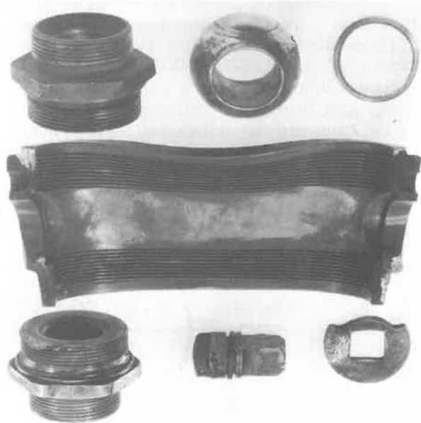
Bild 2 Durch Explosion bewirkte Zerstörung eines Kugelhahnes Verhinderung solcher Zerstörungen mit den gezeigten Ausmaßen durch Einsatz von der Bauart nach geprüften und zugelassenen Einrichtungen, welche die sicherheitstechnischen Anforderungen der zuständigen Arbeitsschutz-Rechtsvorschriften erfüllen
