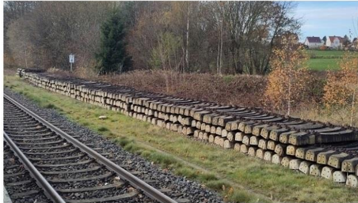
Betonschwellen-Proben der DB Netz AG | Quelle: DB Netz AG
