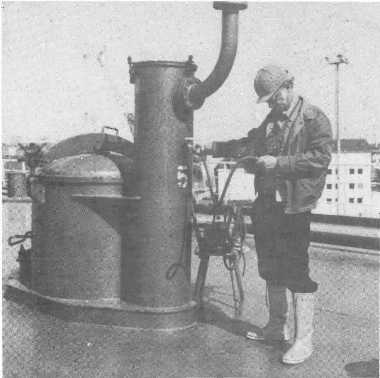
Überwachung des Inertisierungszustandes der Ladetanks eines Rohöltankers durch Messung der Sauerstoffkonzentration. Als inertisiert gelten die Tanks, wenn in ihnen der Volumengehalt an Sauerstoff kleiner als 5 % ist und ein Überdruck von mehr als 20 mbar herrscht. Die Messungen wurden im Mai 1975 auf dem auf der Schiffswerft Blohm & Voss AG., Hamburg, eingedockten 230.000 tdw großen norwegischen Tanker „Thorshammer“ ausgeführt.
