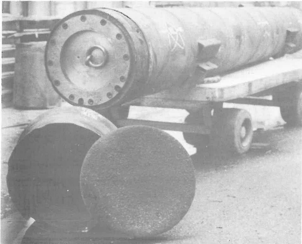
Verpackung für unbestrahlte Kernbrennstäbe nach Fall- u. Feuerversuchen (qm-Freifall, 800 °C Feuer über 0,5 h) Zugelassen unter der Nr. D/DB-0014B
