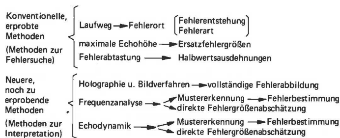
Bild 5 Mögliche Verfahren der Anzeigeninterpretation bei der US-Prüfung
