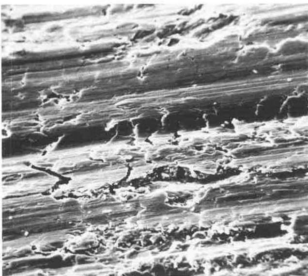
Bild 5 Zerrüttungsrisse auf einer tribologisch beanspruchten Eisenoberfläche
