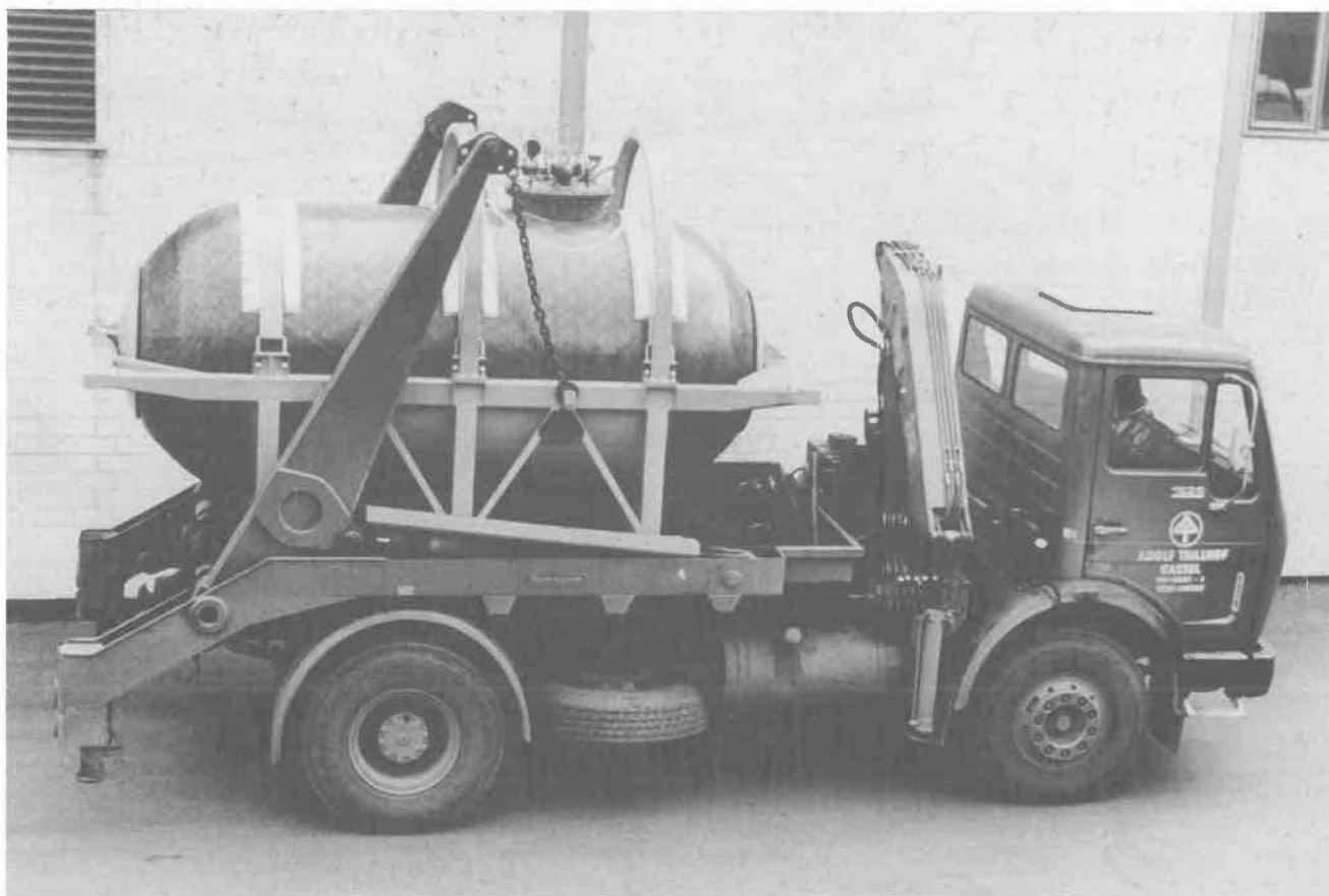
Erster von der BAM zugelassener GFK-Tank zur Beförderung gefährlicher Güter (Zulassungsnummer D/17001/GFK)
