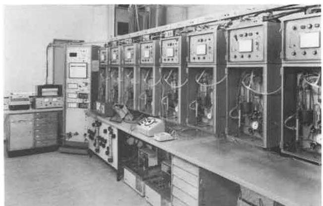
Bild 5 "Oxyflux 3" 1975 auf dem Prüfstand der BAM (Hersteller Dr. Thiedig + Co., Berlin).
