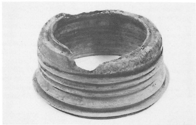
Abb. 9 Gummirillenring für Abflußrohre – durch Mikroorganismen geschädigt
