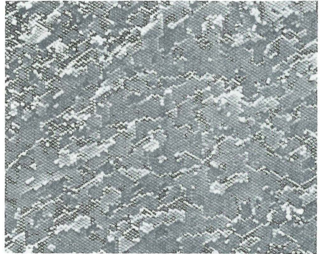
Abb. 7 Rasterelektronische Aufnahme einer Bruchfläche eines Opals
