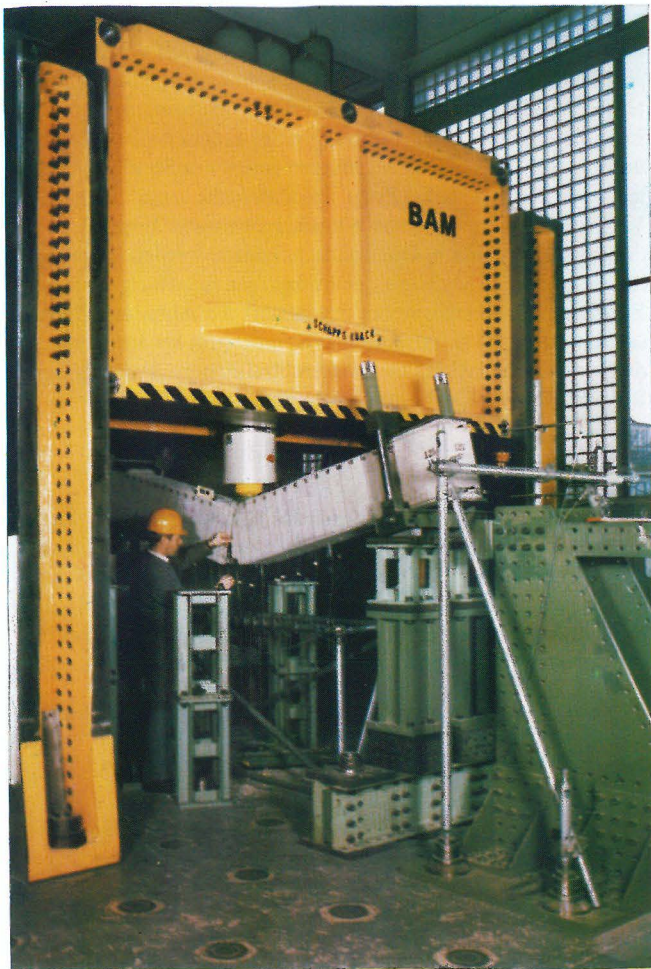
Servohydraulische Versuchseinrichtung zur geregelten stoßartigen Beanspruchung großer Bauteile (maximale Prüfkraft 1000 kN, Bruch eines Probekörpers in 1/30 sec erreichbar)
