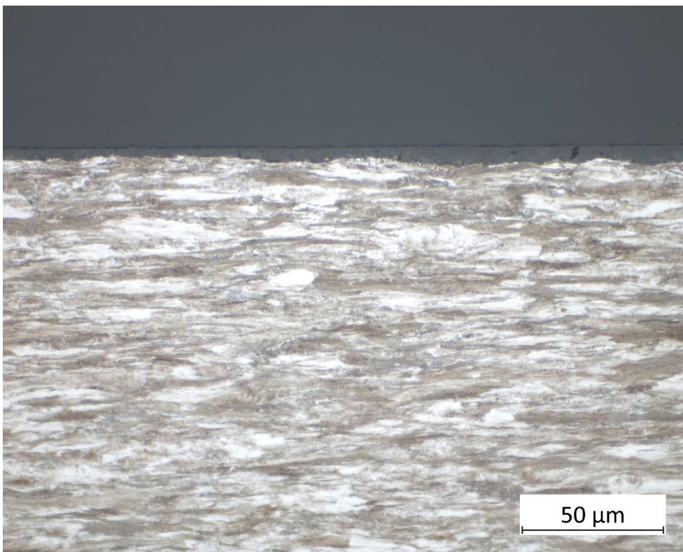
Abbildung 15: Metallographische Aufnahme des CDS-1770 im Randbereich (Längsschnitt).
