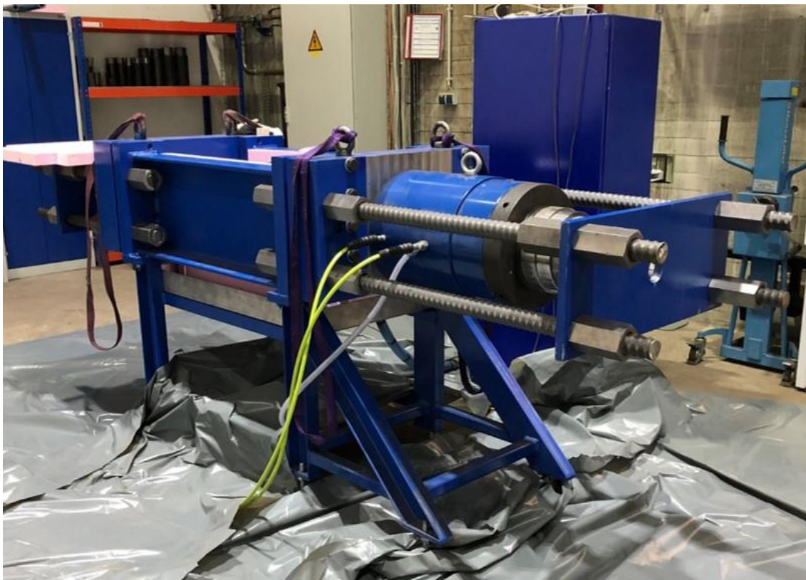
SAH-Abbildung 9: Neu gebauter 3 MN Spannungsrissskorrosionsprüfstand bei SAH nach Fertigstellung
