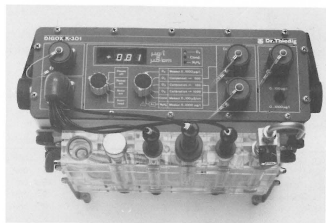
Abb. 4 Schaltgerät des tragbaren Kesselspeisewasser-Analysators DIGOX K-301 (darunter: Analysatorblock, liegend)
