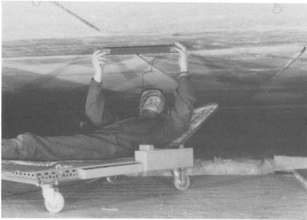
Abb. 1 Setzdehnungsmessung an einem schwer zugänglichen Stahlbetonbauwerk (b) Setzdehnungsmesser mit 500 mm Meßlänge, Weiterentwicklung der Bauart Pfender (a) (Bild BAM-6.1)
