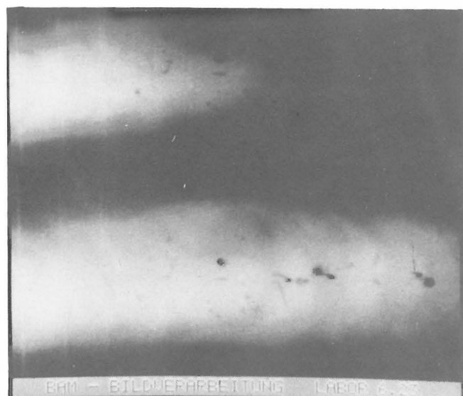
Abb. 4.2 Ausleuchtungskorrektur bei einer Durchstrahlungsaufnahme aus der Schweißnahtprüfung
