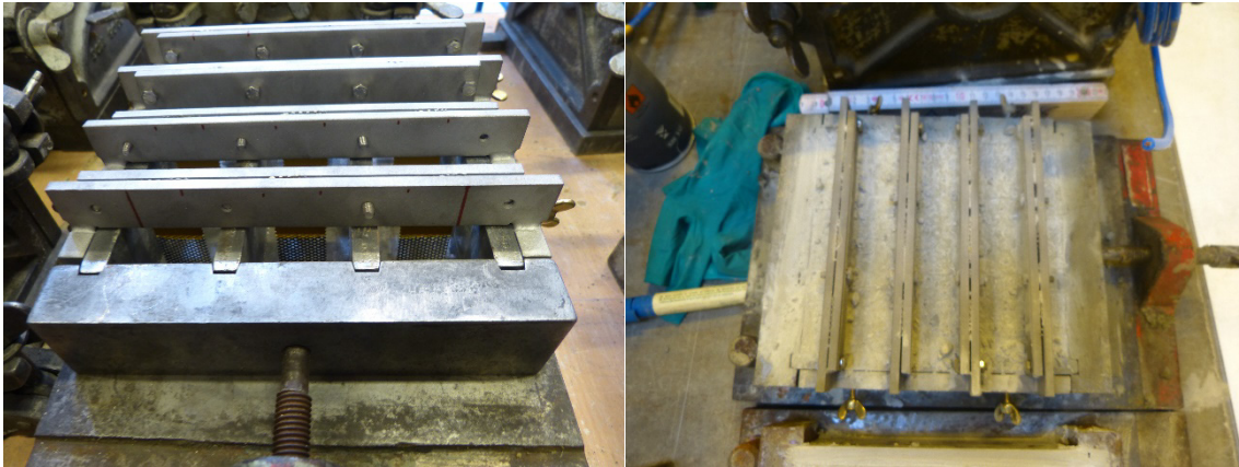
Abb. 8: Prismenschalung mit Elektroden zur Bestimmung des spezifischen Elektrolytwiderstands links, rechts, fertige Probekörper in der Schalung
