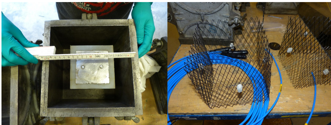
Abb. 36: Stahlschalung mit Silikonkörper links und Bezugs- und Gegenelektroden für die Prüfkörper rechts.
