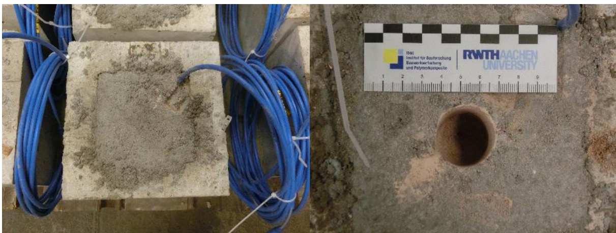
Abb. 14: Einbau der Serien B2 und B3, Grundprüfkörper vor (links) und nach Bohrung (rechts)
