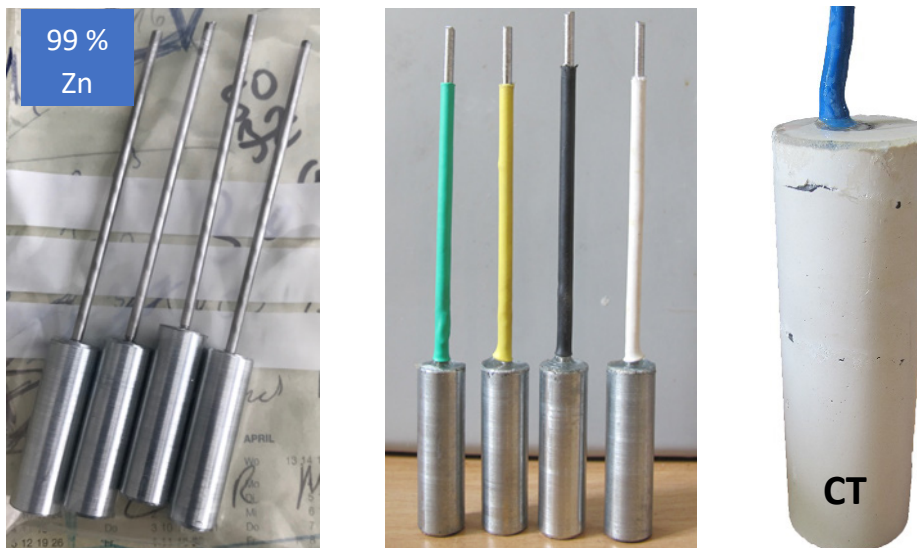
Abb. 6: Links, Zinkanoden mit elektronenleitender Verbindung aus 1.4571, Mitte für die Einbettung in Einbettmörtel vorbereitete Zinkanoden und rechts Zinkanoden für die CT-Untersuchungen in Einbettmörtel des Herstellers C
