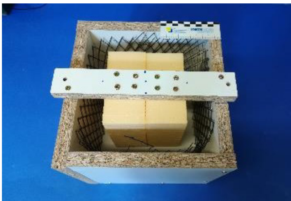
Abb. 12: Prüfkörperschalung mit Füllkörper und MMO-Netz
