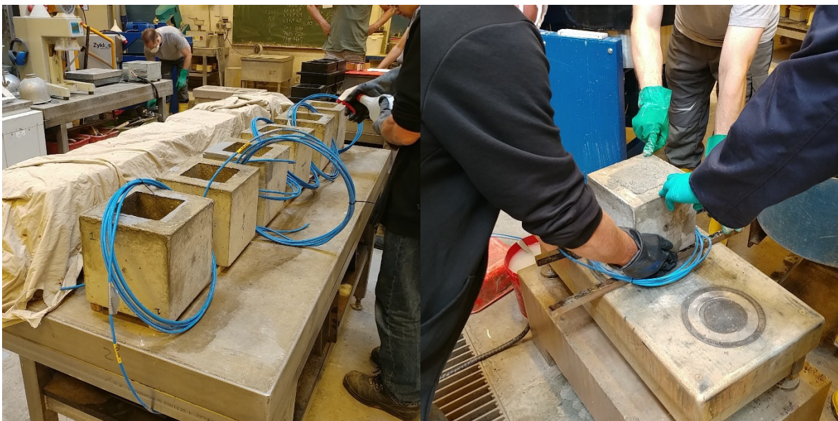
Abb. 38: Vorbehandlung der Prüfkörper für das Einbringen der Anoden links und verdichte des eingebrachten Ankoppelmörtels auf dem Vibrationstisch rechts.
