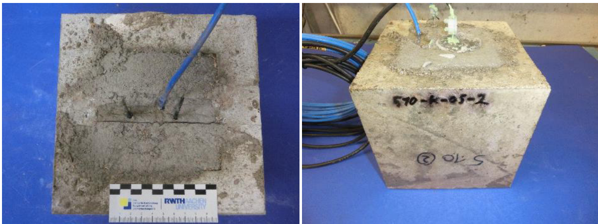
Abb. 13: Fertiggestellter Prüfkörper der Hauptversuchsreihe (links), Prüfkörper der Serie Klima-OS nach Auftrag Grundierharz(rechts)
