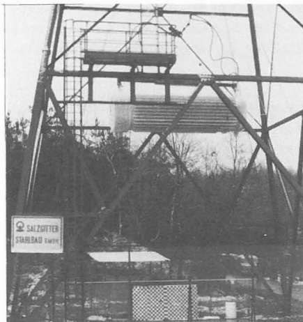
Abb. 5 Fallversuch mit einem auf -40^{\circ}\text{C} abgekühlten Prototypen
