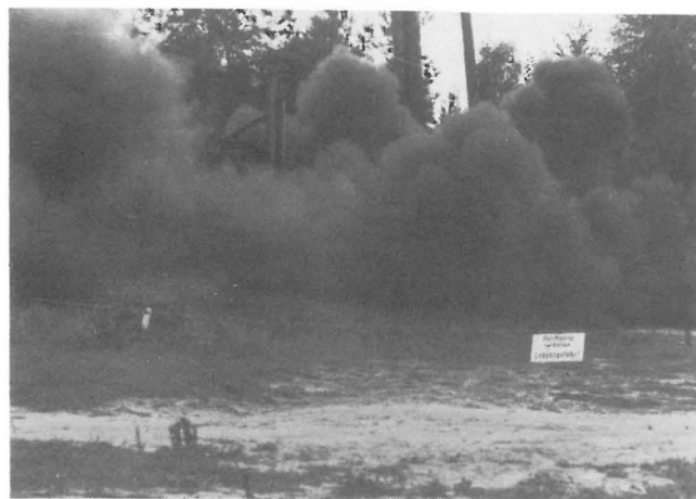
Abb. 3 Nach dem Bersten einer Acetylenflasche
