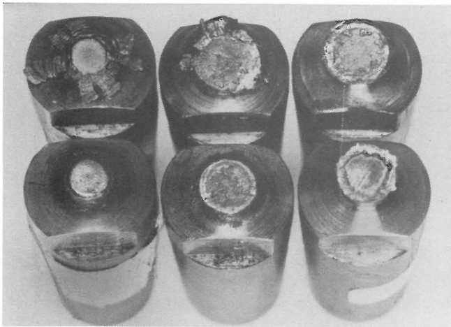
Abb. 12 Beispiele für den Verschleiß von Punktschweißelektroden
