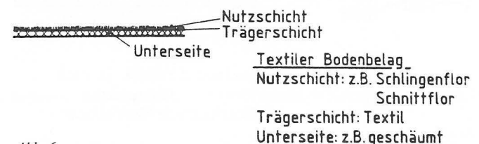
Abb. 6 Mehrschichtiger textiler Bodenbelag hoher Trittschalldämmung
