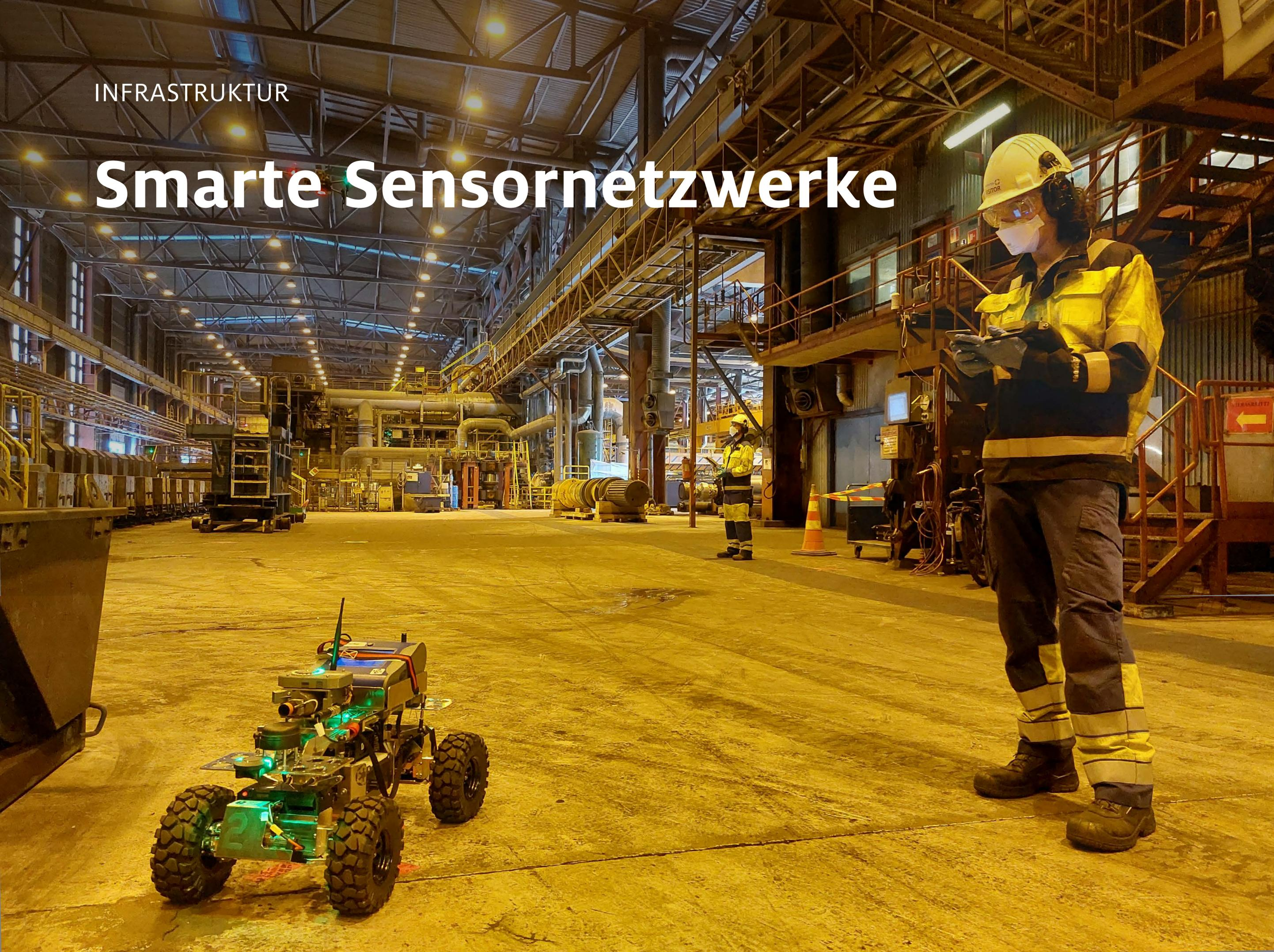
**In Industrieanlagen können toxische Gase und Feinstäube freigesetzt werden. Ein von der BAM entwickeltes smartes Sensornetzwerk hilft, den Schadstoffgehalt der Luft genauer zu ermitteln und Menschen zu schützen.**
