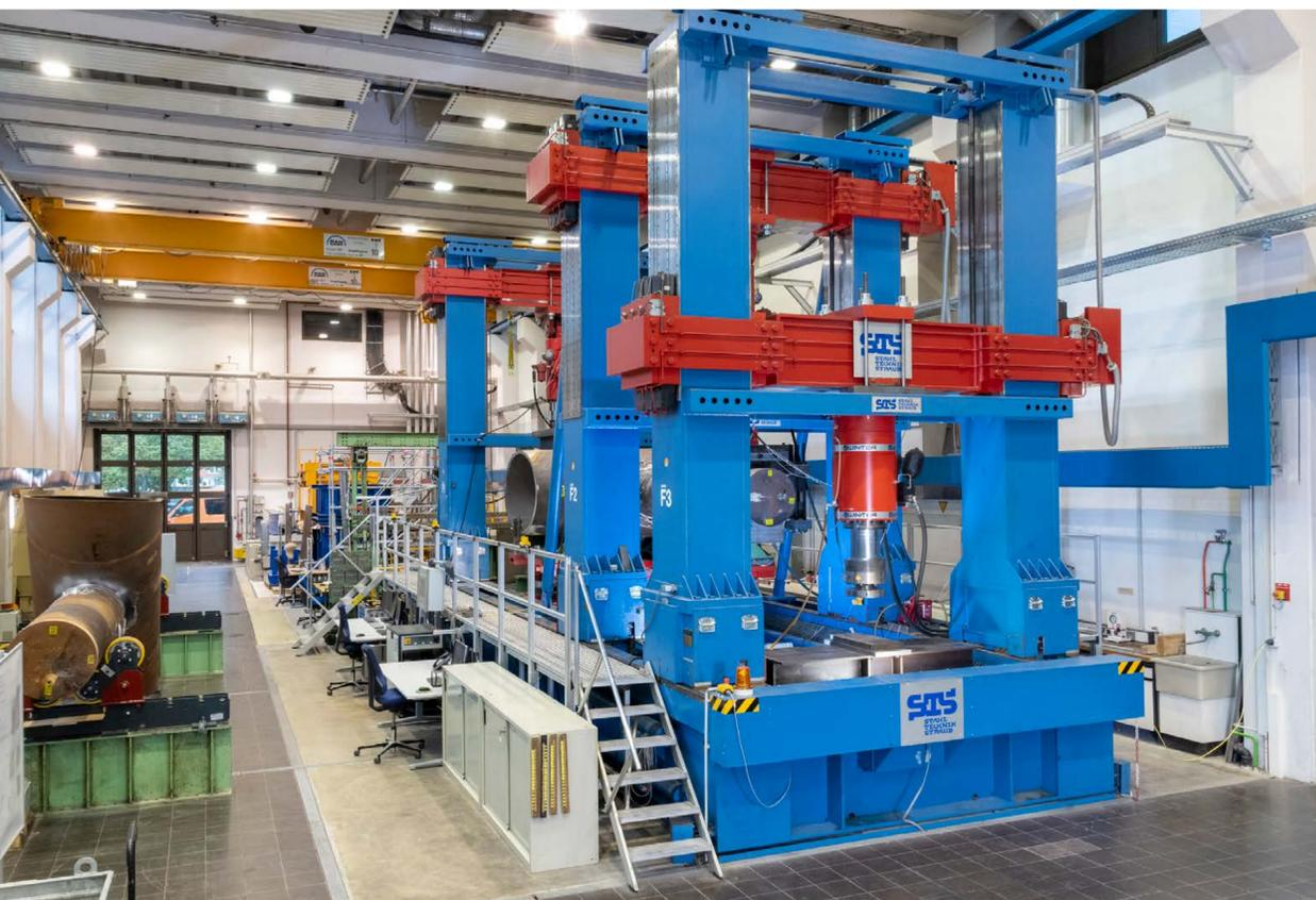
Im Großprüfstand des Kompetenzzentrums werden Stahlbauteile gezielt Stresstests ausgesetzt.
