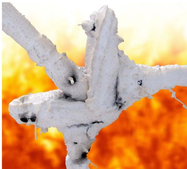
Reaktive Brandschutzsysteme erzeugen eine schaumartige Dämmschicht. Sie verzögert die Erwärmung des Stahls.
