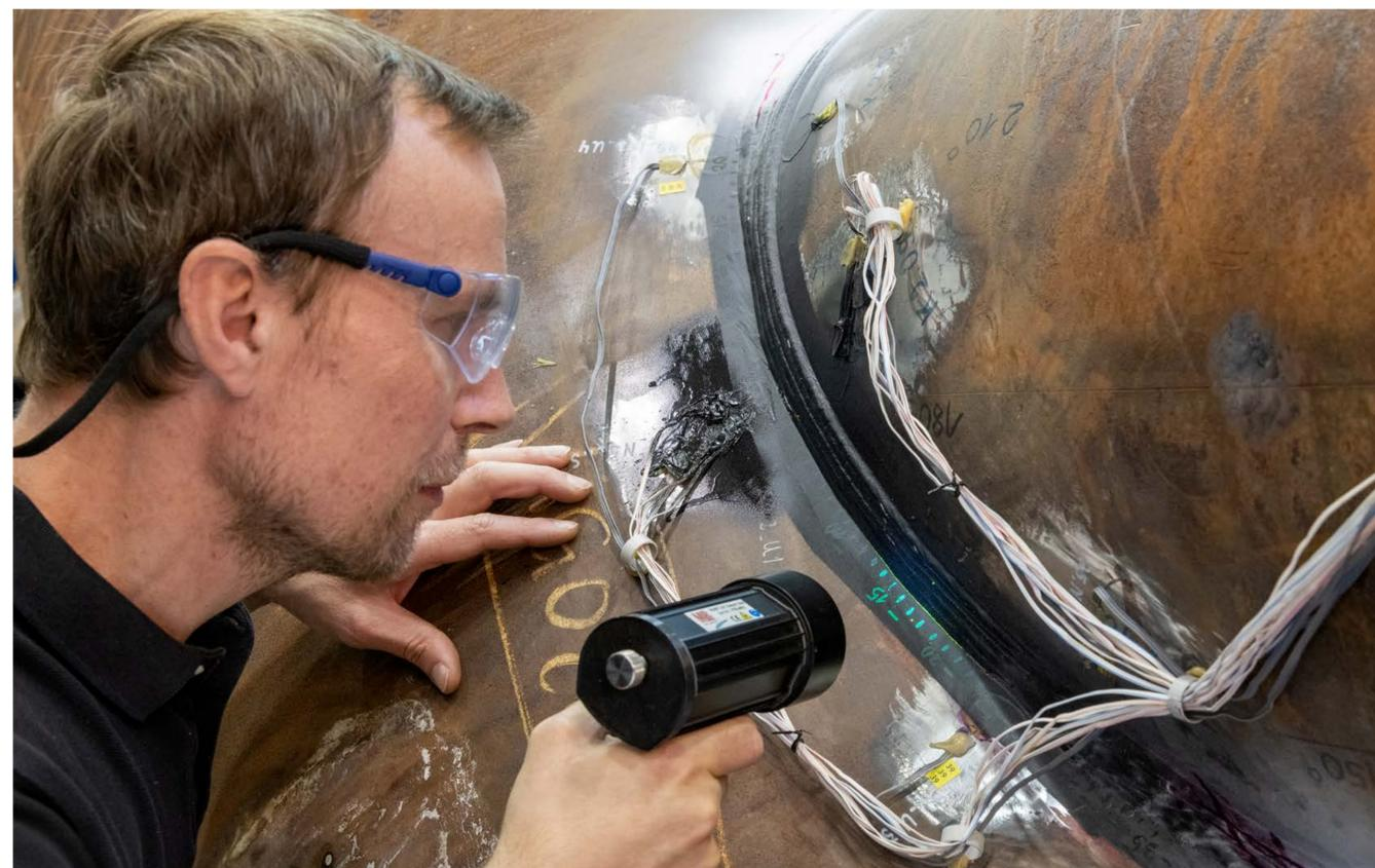
Mittels Fluoreszenz lassen sich Schweißnähte an den Tragstrukturen von Windrädern auf Risse überprüfen.
