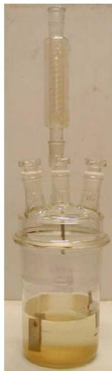
Zur ordnungsgemäßen Durchführung der Prüfung muss von dem zu klassifizierenden Stoff mindestens ein Volumen von 1,5 Litern verwendet werden, um sicherzustellen, dass während der gesamten Auslagerungszeit genug reaktionsfähiges Material vorhanden ist. Sehr lange Prüfzeiträume ohne Wechsel der Prüfsubstanz können negative Ergebnisse liefern. Um richtige Ergebnisse zu erhalten und um Wiederholungsprüfungen zu vermeiden, sollten folgende Punkte beachtet werden:
