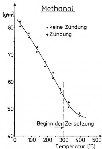
Abb. 4 Temperaturabhängigkeit der unteren Zündgrenze von Methanol (Luftvolumen bezogen auf 0 °C und 1.013 hPa)
