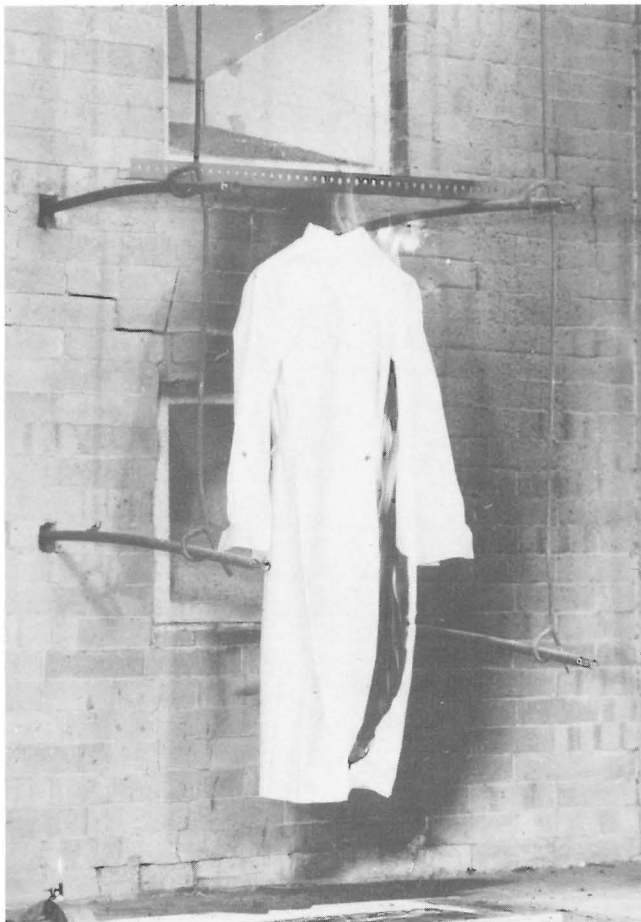
Abb. 4 Brennversuch an Baumwollkittel (184 g/m 2 ), 30 s nach Zündung
